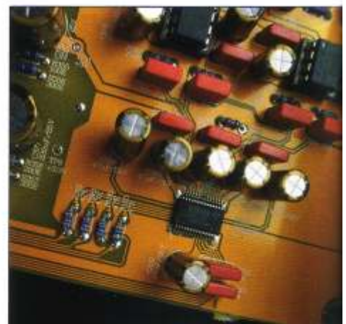
Der D/A-Wandler kann per Upsampling mit bis 192 kHz/24 Bit angefahren werden
