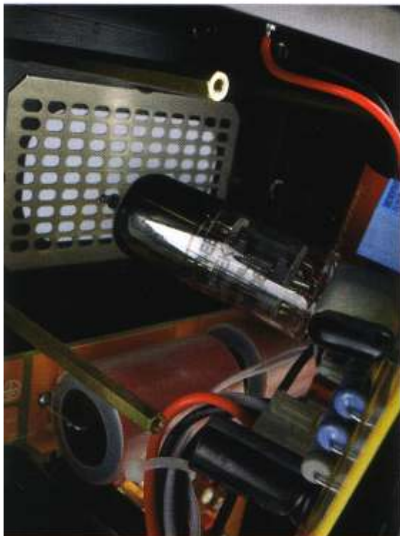
Die Ausgangsröhren bereiten im Class-A-Betrieb das analoge Ausgangssignal auf
